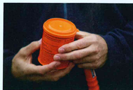
Der Rauchsignaltopf wird im Notfall sofort der über Bord gegangenen Person hinterhergeworfen und markiert dann deren Position.
