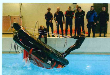
Vorgezogen: So dreht man die umgekippte Rettungsinsel in die richtige Position. Bei hohem Seegang wirklich anspruchsvoll!
