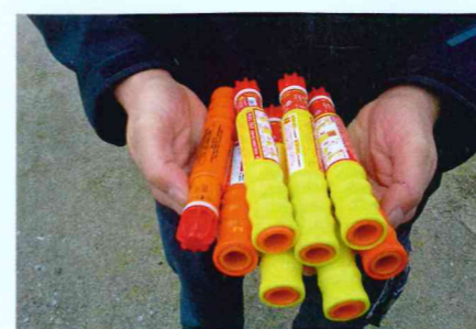
Rot-weiß-rot: Handfackeln mit rotem (orangefarbenem) oder weißem Licht werden bei Bedarf gezündet, wenn andere Schiffe in der Nähe sind.
